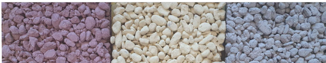
Sickerbeton mit Farbzuslag
